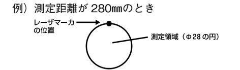
測定距離が280mmのとき、レーザーマーカは測定領域の上の位置を指します。測定の目安としてください。
